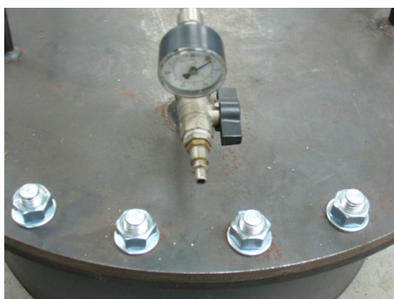
FIG.5) Messa in pressione del serbatoio per verifica della tenuta
