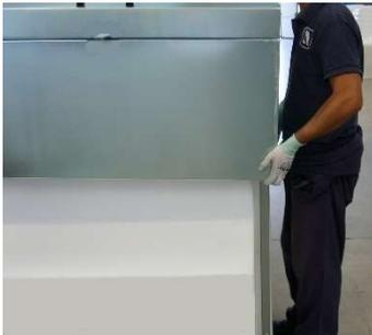
FIG.9) POSIZIONARE IL CASSONE SOPRA ALLA PARTE SUPERIORE DELLA STRUTTURA
